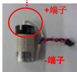
請將+端子的導線朝右水平方向插入，使+端子的導線（○部）收納到外殼內的槽（□部）中。
