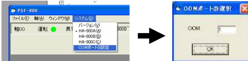
设定②中确认的端口号，点击 [OK] 按钮。然后，启动 PSF-800 后，启用刚才设定的 COM 端口号（1~16）。
