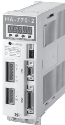
HA-770 驅動器是驅動超高解析度、精密定位用直接驅動馬達 KDU 系列的專用驅動器。
