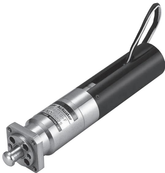
LA 系列是兼具小型、高解析度、高推力的線性致動器。該系列達到最大推力為 49N，解析度為 0.0174 $\mu$ m 的高精度。
