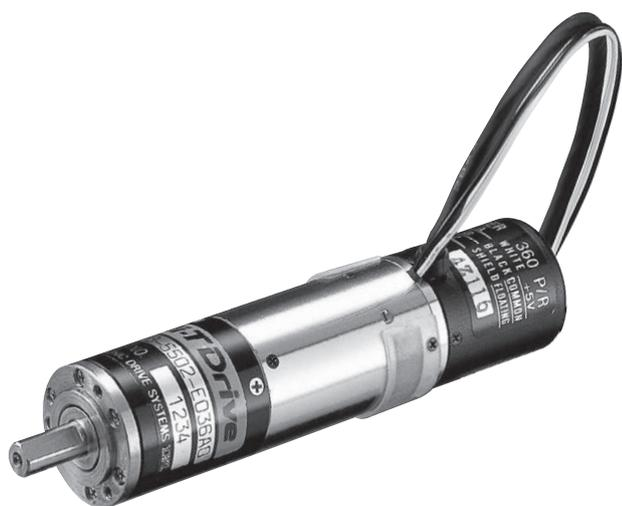
RH 系列組合了精密控制用減速機 Harmonic Drive® 與 DC 伺服馬達，小型、高轉矩、高旋轉精度的 DC 伺服致動器。藉著搭配能充分發揮 RH 系列性能的專用伺服驅動器，才能推出此款擁有高旋轉精確度，以及精巧設計的機器設備。
