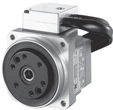
FHA-C mini 系列是結合了薄型、精密控制用減速機 Harmonic Drive® 與超薄型 AC 伺服馬達的 AC 伺服致動器。增加輸入電源電壓 DC24V 的新規格。
